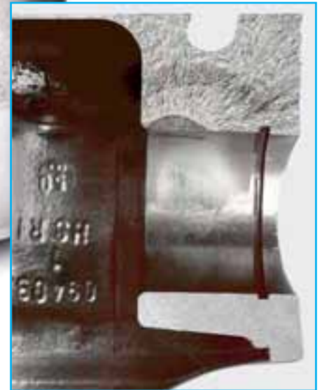
рис. 2 Поперечное сечение бобышки поршня
